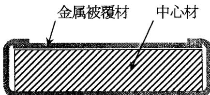
アスベストその他の耐熱材料（クッション材）を中心材として、金属薄板で被覆したもので、配管等の接合部の密封に使用される。
