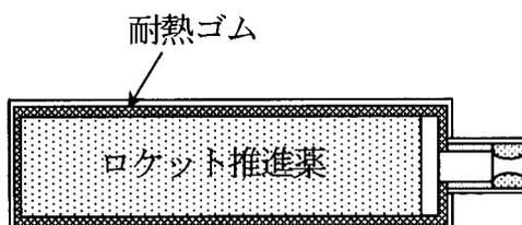
ロケットモータ内の推進薬が燃焼する際に発生する高温・高圧の燃焼ガスからモータケースを保護するために使用されるアスベストを含有する耐熱ゴムである。
