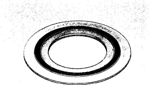
テープ状の波形金属板（フープ）と、アスベスト、合成樹脂などのクッション材（フィラー）を交互に重ね、うず巻き状に巻き上げ板状のリングにしたもので、配管等の接合部の密封に使用される。
