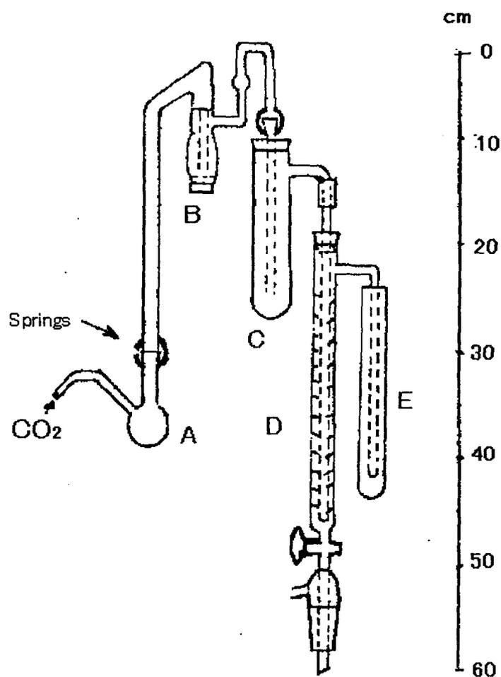
(2) 操作法 冷却捕集管 B に赤リン 0.06g を水 100 ml に懸濁したものを満たし, 吸収管 C に硝酸銀・エタノール試液 10 ml, 吸収管 D にオキシエチレン測定用臭素・臭化カリウム試液 15 ml, 吸収管 E にヨウ化カリウム溶液 (1 → 10) 10 ml をそれぞれ
