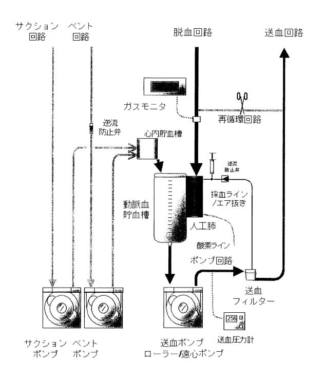
図3-13 体外循環回路に動脈貯血槽を有する回路の例
